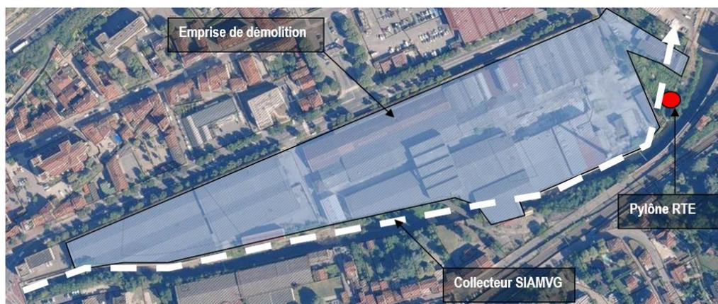
Figure 6 : Réseaux impactés en rive gauche
