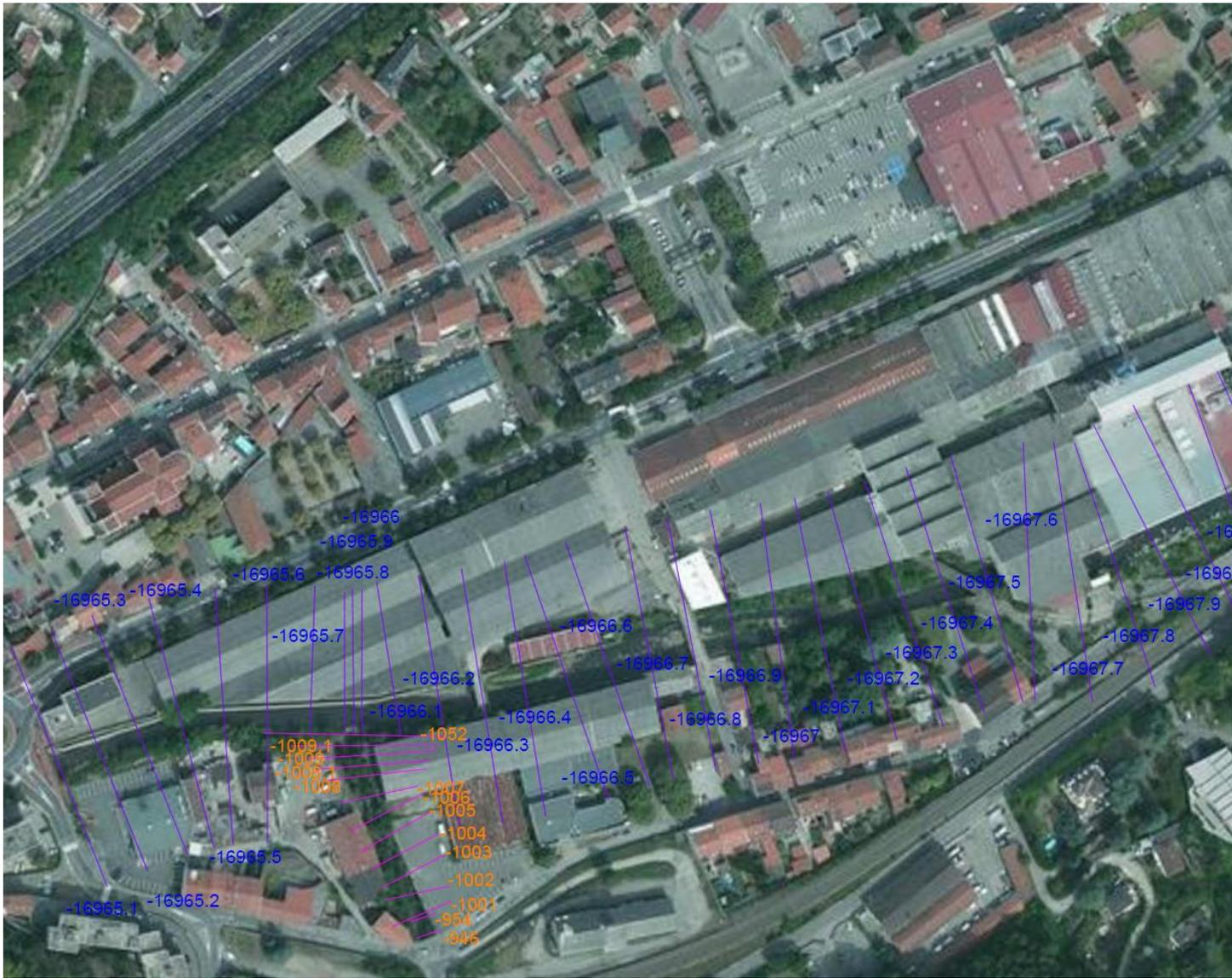
Figure 82 : Localisation des profils en travers utilisés pour le modèle hydraulique
